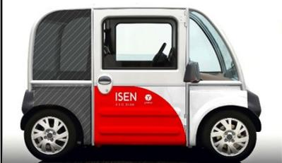
Dans le cadre de création du domaine professionnel mobilité électrique de la formation d'ingénieurs portée par Yncréa Ouest, l'unité de recherche s'est dotée d'un véhicule électrique F-City. Dans le cadre des projets étudiants M1, en lien avec les membres du laboratoire, ce véhicule a été instrumenté pour estimer la consommation d'énergie en fonction des différents profils routiers.
